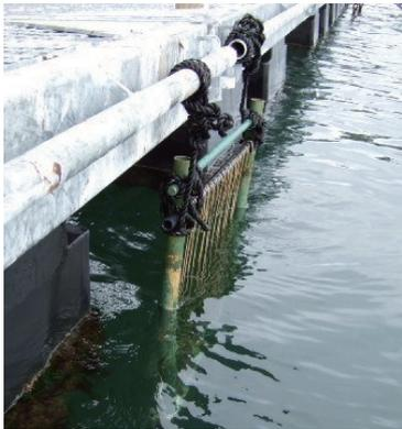
図3 海中暴露試験状況.
