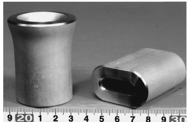
図4 開発したDP28Wシームレス鋼管(押し広げおよび扁平試験後の外観).
