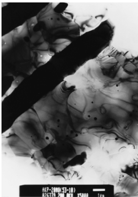
図2 アルミナマトリックス中における扁平 Mo 粒子とナノ Mo 粒子の分散を示す TEM 像.
