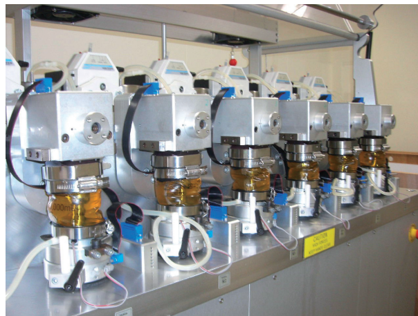
図1 股関節検査システム(股関節シミュレータ)：実際の股関節が受ける荷重や変位をシミュレートし、耐摩耗性を調査できる。
