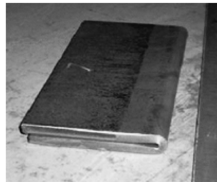
図9 開発鋼の曲げ加工後の外観例。(6 mmt, L 方向, 曲げ半径: 0 t)
