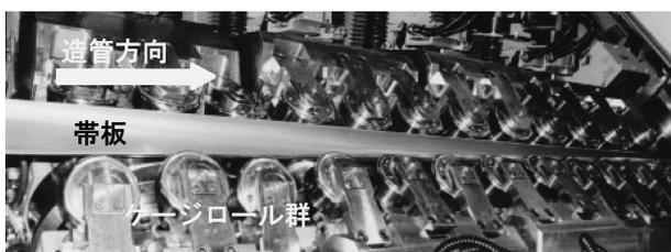
(a) CBR成形ミルのケージロール成形域における帯板の成形状態(センターベンドロールを外した状態で撮影)
