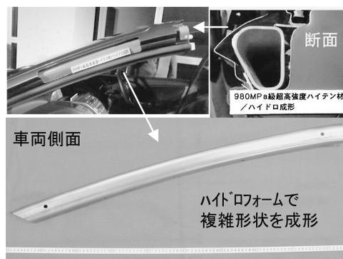
図7 TS980 MPa 鋼管のフロントピラーリンフォースメントへの適用例。
