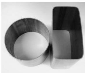
図6 TS980 MPa 級鋼管の角管リロール加工例。
