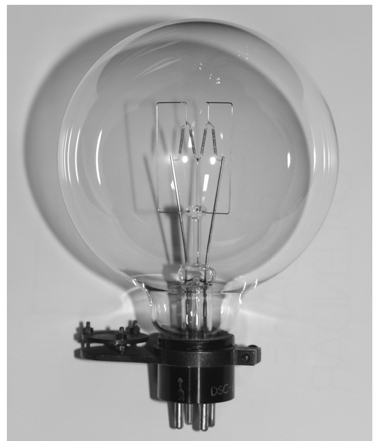
図 2 コイル M 字型光度標準電球。M 字型に張られたコイルフィラメントにより、基準面が厳密に規定される。
