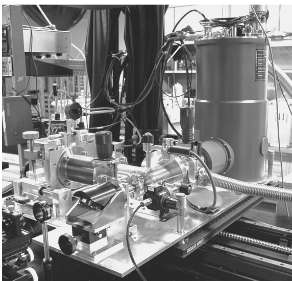
図 1 NMIJ 高精度分光応答度校正装置に組み込まれている電力置換型極低温放射計(右奥)。補正係数として入射窓透過率を精密測定するため、光検出器が内蔵されたチェンバーを付設する。
