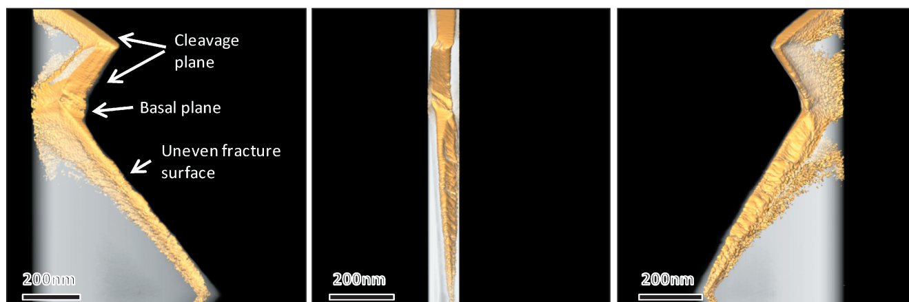
Fig. 2 破面形態が良く分かる方向から見た 3D 再構成像.
