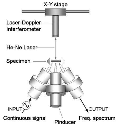
図1 RUS/LDI 計測の模式図。試料には自重以外の外力が働かないため、自由振動状態と見なすことができる。
