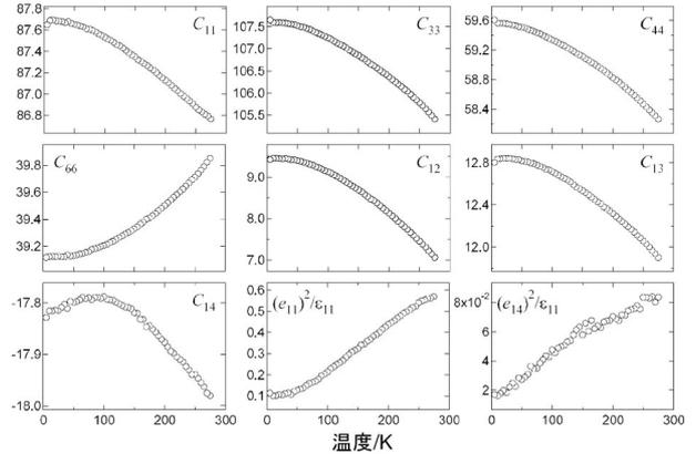
図4  $\alpha$ -SiO<sub>2</sub> の低温域における弾性・圧電定数計測結果. 単位は全て(GPa).
