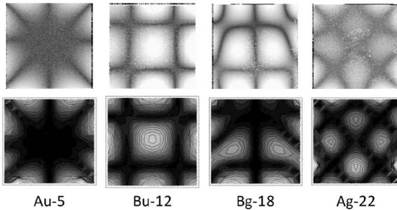
図3 共鳴状態における試料表面の変位分布 ( $A_u$ -5,  $B_g$ -12,  $B_g$ -18,  $A_g$ -22). 図上段は RUS/LDI 法による計測結果を, 下段は Rayleigh-Ritz 法による計算結果を示す.
