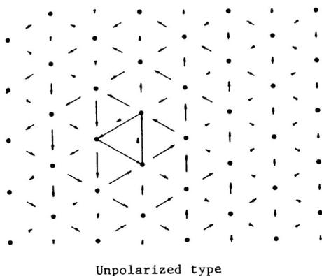
図2・10 モデル鉄結晶中のらせん転位の芯構造の計算結果の一例：Vitek表示。
