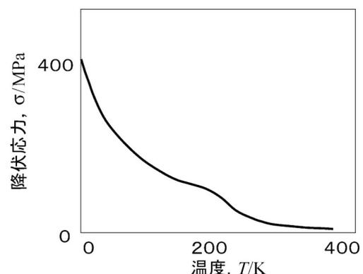
図2・11 超高純度の鉄単結晶の降伏応力の温度依存性。
