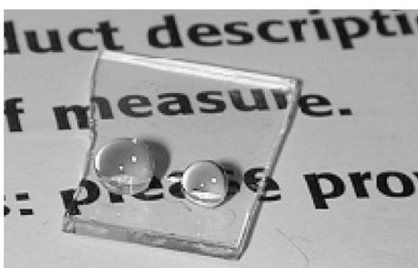
図1 ガラス上に成膜した超はっ水表面上の水滴の様子。
